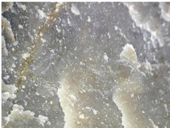
Слика 2, Структура кречњака из каменолома Вчеларе (Словачка) Figure 2, The structure of limestone from the Včeláre quarry (Slovakia)
